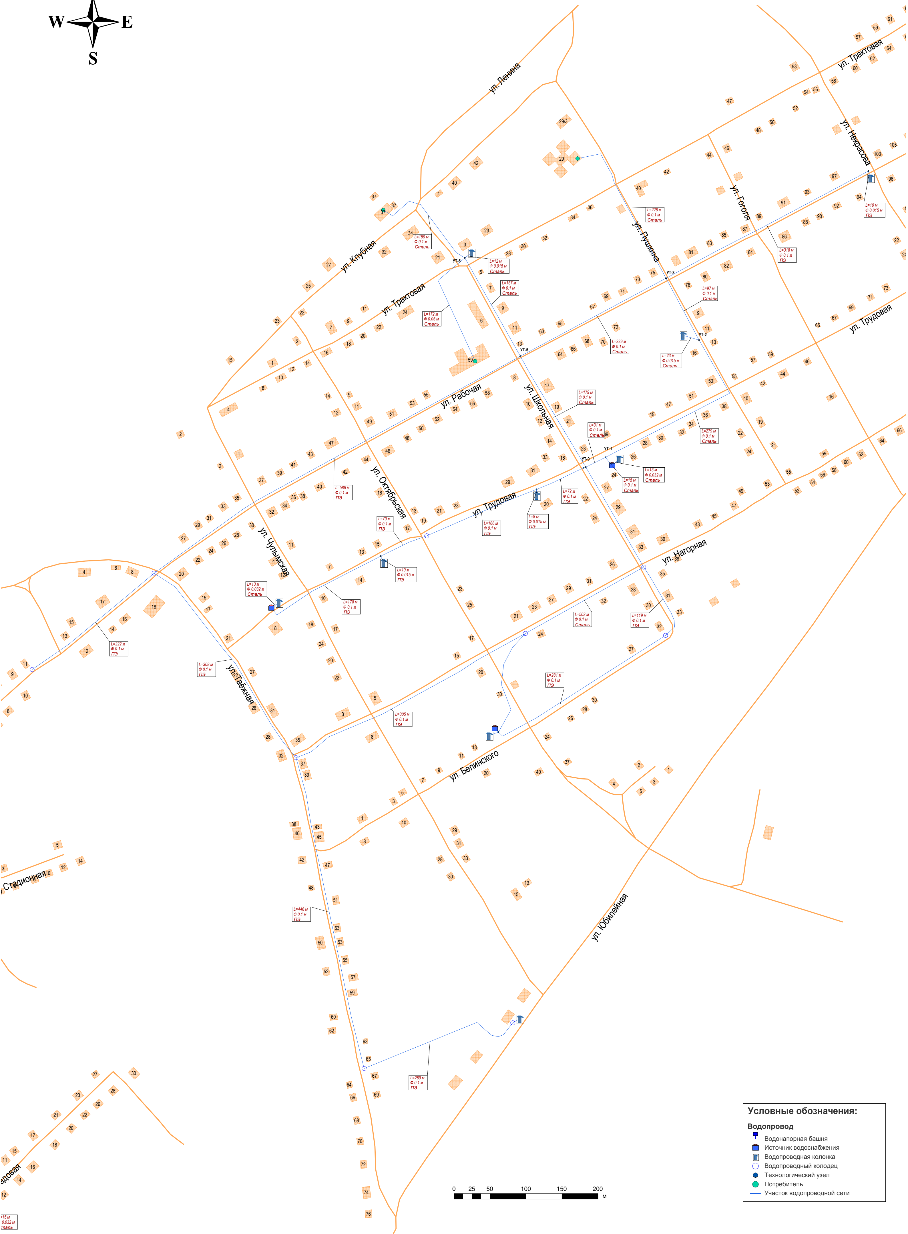
Приложение 2.1. Схема перспективной водопроводной сети села Батурино (восточная часть села)
