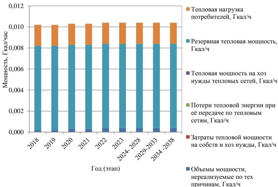
Рисунок 1.10 – Существующие балансы тепловой мощности источников тепловой энергии и тепловой нагрузки потребителей котельной № 4
