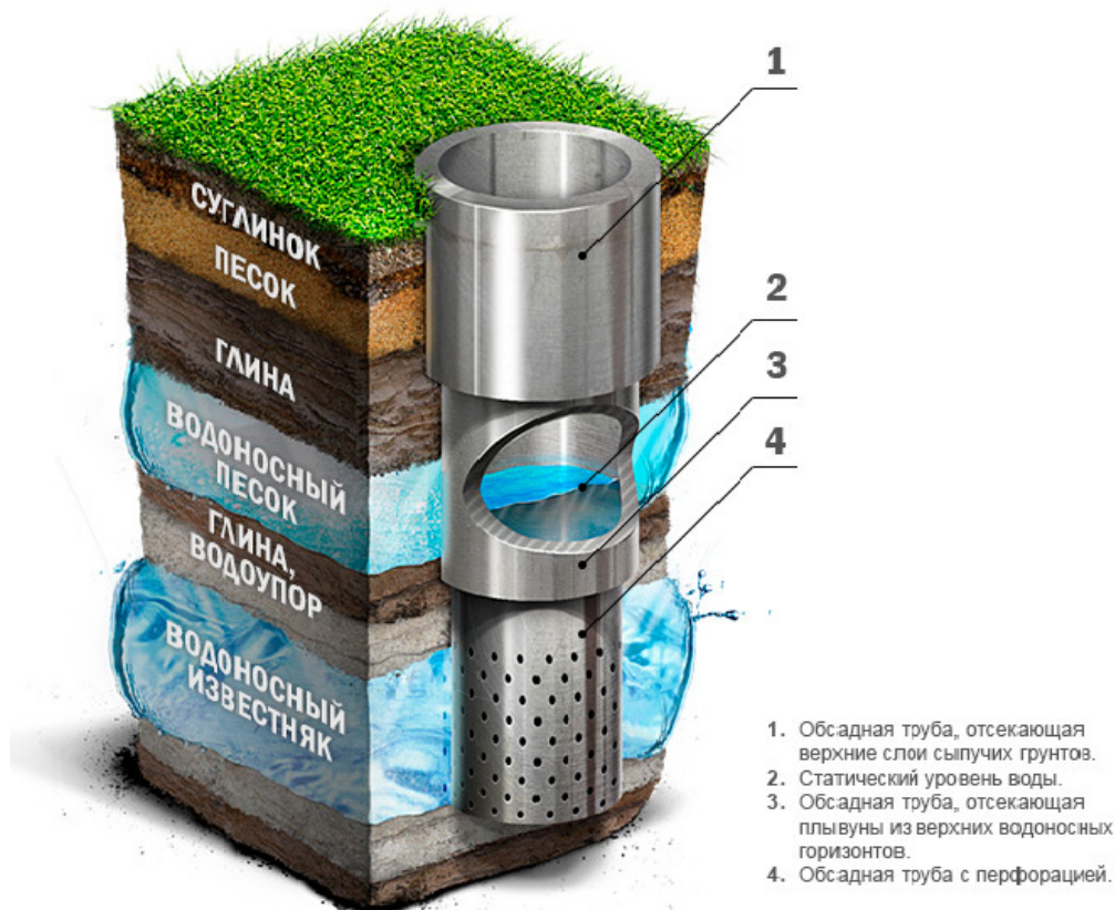
Рис. 4.1. Конструкция артезианской скважины
