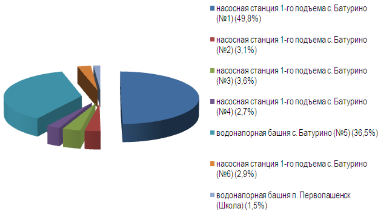
Рис. 3.2. Распределение подачи воды по технологическим зонам водоснабжения Батуринского сельского поселения
